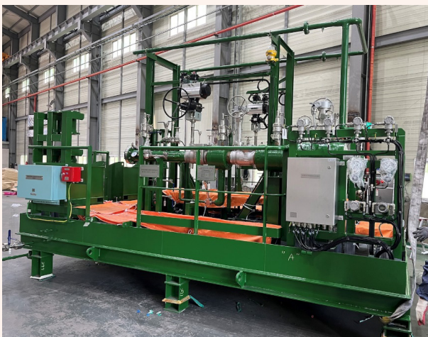
LNG Low Pressure Vaporizer Skid
